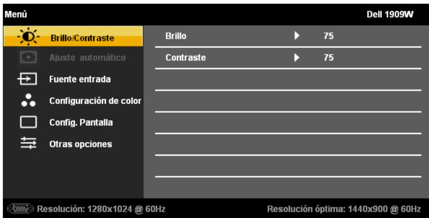
**NOTA:** La función de AJUSTE AUTOMÁTICO sólo estará disponible si utiliza el conector analógico (VGA).
